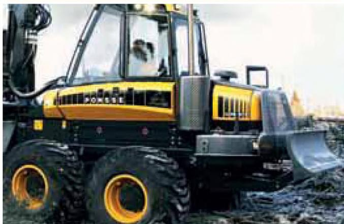
Мощный отвал бульдозера для перемещения грунта, снега и т.п.
