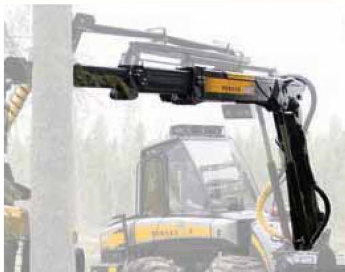
Комплекты деталей для усиления крана сводят к минимуму образование трещин и механические напряжения на кране.
